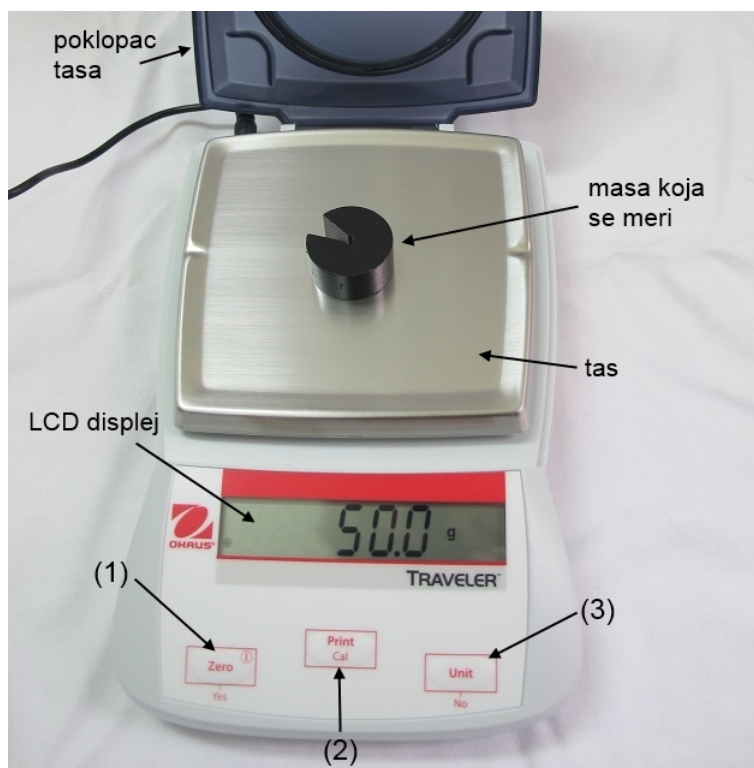
Slika 2.6: Digitalna vaga opsega 0-3000 g; tačnost 0,1 g; rezolucija 0,1 g.
